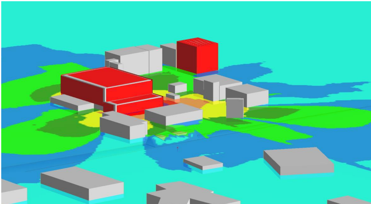
Figure 33 : Simulation du bâtiment principal (sources rayonnantes surfaciques)
